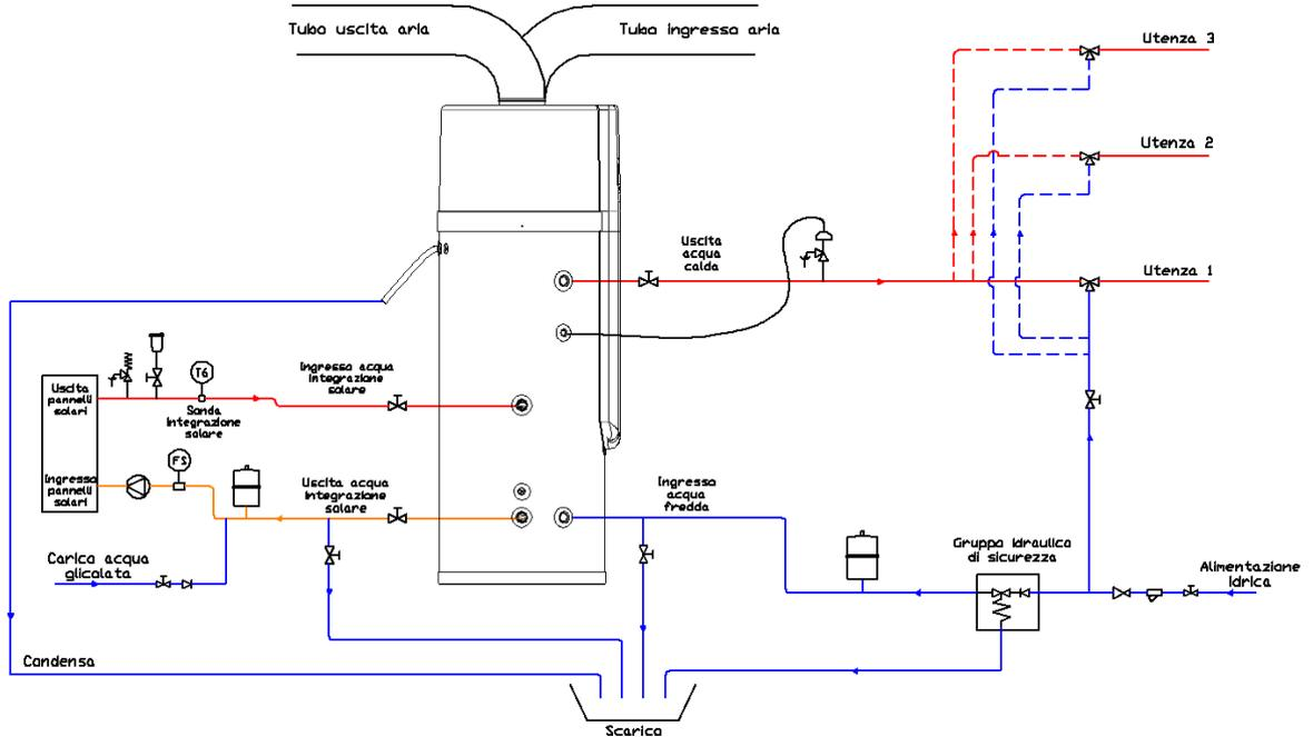
Schema di installazione in caso di ricircolo di acqua di integrazione solare
