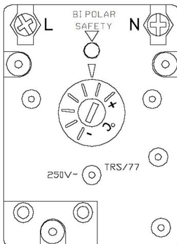
La resistenza elettrica di integrazione è equipaggiata con un termostato di regolazione; l'accesso a questo componente avviene rimuovendo la copertura frontale in plastica. Tale controllo permette una variazione di temperatura compresa fra 15 e 75 °C; ogni tacca di regolazione corrisponde ad un salto termico di 10°C.
